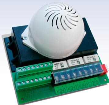
Содержит три реле для управления этажными клапанами дымоудаления, подпора воздуха и компенсационным клапаном. Обеспечивает контроль их закрытия.
