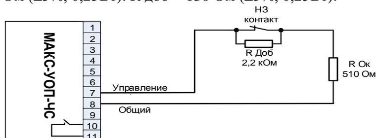
Рис.3. Схема подключения Входа «Управление» модуля МАКС-УОП-ЧС к НЗ контакту. Рок для входа «Управление» = 510 Ом ( $\pm 5\%$ , 0,25Вт). R доб = 2,2 кОм ( $\pm 5\%$ , 0,25Вт).
