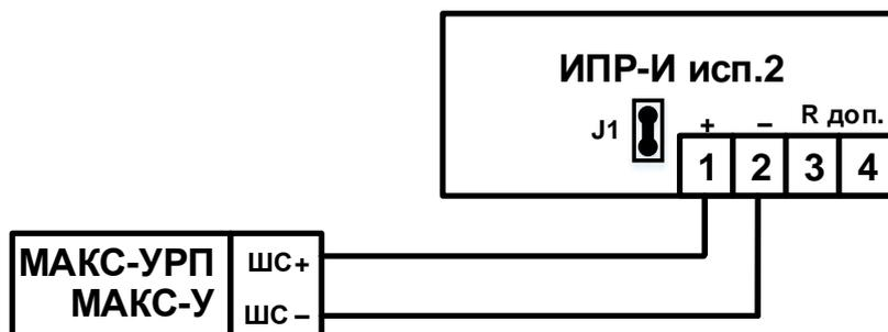
Рис 2. Включение УДП-И исп.2: (а) - в режиме формирования сигнала Пуск; (б) - в режиме формирования сигнала Внимание; (в) - в режиме нормально разомкнутой кнопки ДУ.
