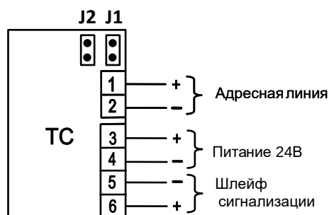
Рис. 2. Назначение клемм адресных меток МАКС-ТС.
