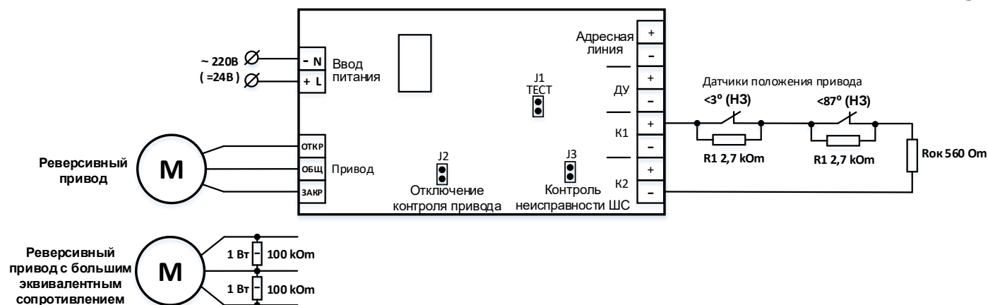
Рис.4. Схема подключения реверсивного привода к МАКС-УРП исп.2. Использовать датчики положения привода с НЗ-контактом. Резисторы R_{ок} = 560 \text{ Ом} , R_1 = 2,7 \text{ кОм} ( \pm 5\% , 0,25 Вт).
